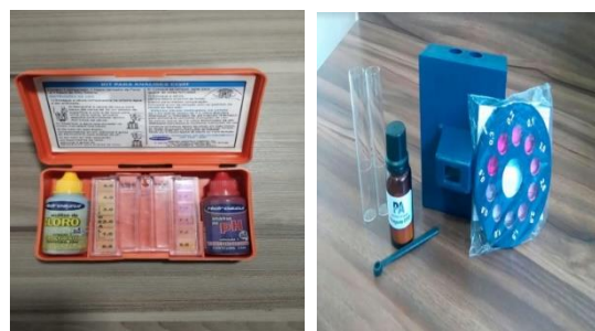
A B Figura 2: Kit de cloração da água, método DPD (A) e Kit de pH, método colorimétrico (B). Fonte: SISAR-BSA, 2024.
