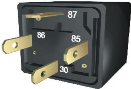
Alguns circuitos consomem correntes além daquelas que poderiam ser suportadas pelos interruptores convencionais, necessitando desta forma utilizar relés. Quais os pinos deste relé universal, que pertencem ao eletroímã (bobina do relé)?
