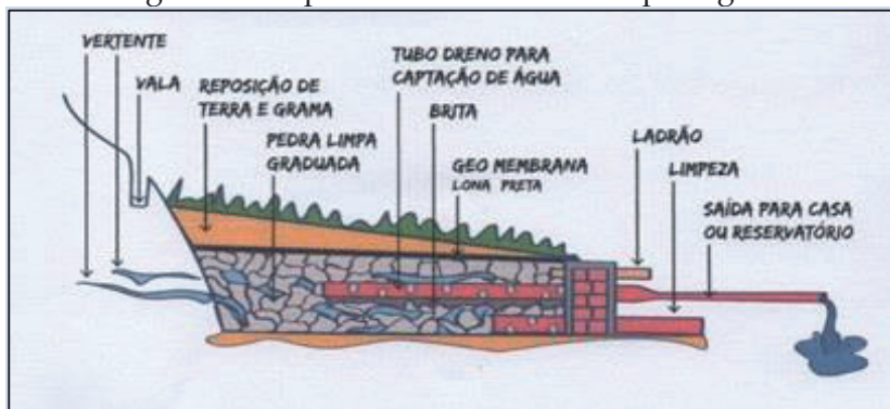
Figura 7 - Esquema de uma nascente protegida
